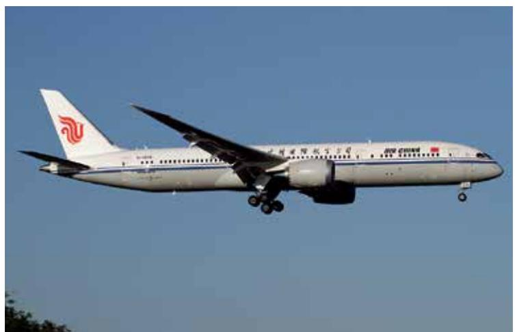
**AIR CHINA B787:** Air China ist eine weiterer Kunde des Dreamliners, der sich mittlerweile mit weltweit ca. 450 ausgelieferten Modellen seit 2011 auf dem Markt durchsetzt. Die hier fotografierte Maschine ist eine B787-9, eine im Vergleich zum Basismodell um 6 Meter gestreckte Langstreckenversion.
