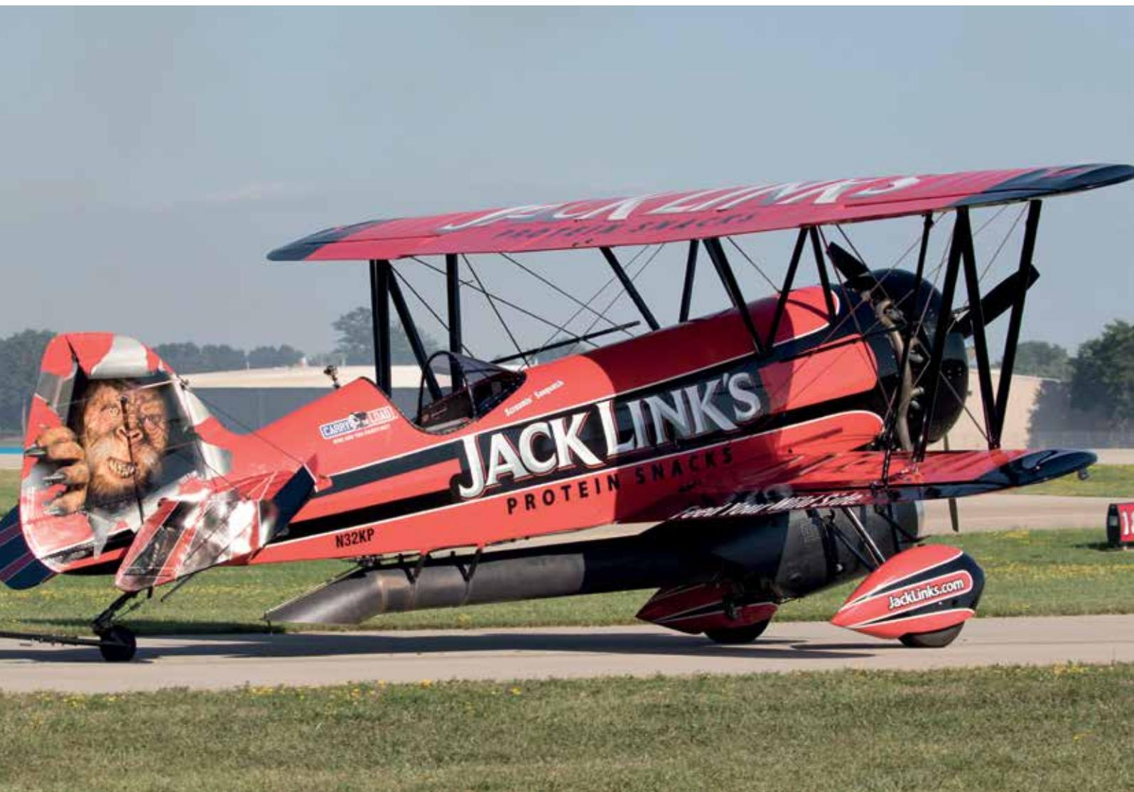
Waco „Screamin’ Sasquatch“: Dieser Doppeldecker hat mehr Schub als er wiegt, durch das zusätzlich unterm Rumpf installierte Jet-Triebwerk, das eigentlich in Learjets verwendet wird. **Photo: Volker Müller**
